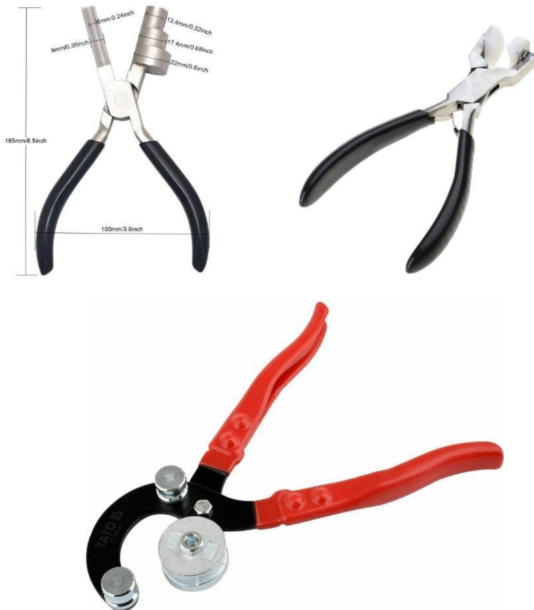
Рис.54 Образцы ручного инструмента для изгиба жил кабелей.
