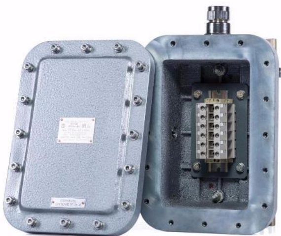
Рис. 2 Внешний вид соединительных коробок с видами взрывозащиты «повышенная защита вида «е»» и «взрывонепроницаемая оболочка «d»»
